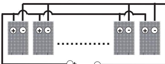
Parallelschaltung für höheren Strom
