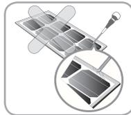
Leiten Sie nicht künstlich gebündelte Sonneneinstrahlung auf die Moduloberfläche. Die Nichtbeachtung kann zur Beschädigung oder zum Versagen des Produkts führen.
